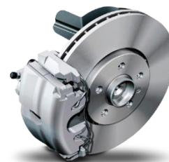
**Paso 4:** Desmontar las pinzas de freno y verificar el estado de las pastillas de freno. Se debe medir el espesor de las mismas, así como realizar una inspección visual en busca de grietas, desprendimientos de material, manchas de vertido de fluidos, etc...
